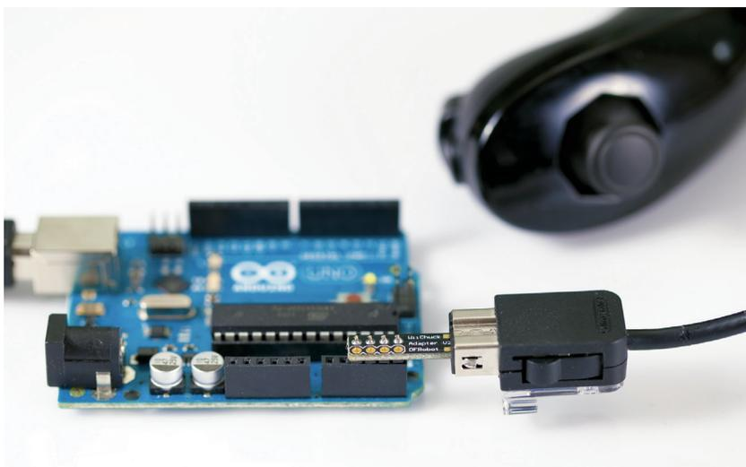
圖 8-7 用 WiiChuck 轉接器將 Nunchuk 與 Arduino 連接
