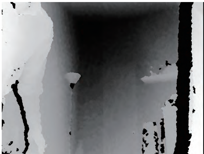
圖 4-2：OpenNI 可以在非常早期的時候確認場景中的使用者。此螢幕截圖取自 onNewUser 回呼函式執行的時候，你可以看到我剛剛進入畫面左側的情況。
